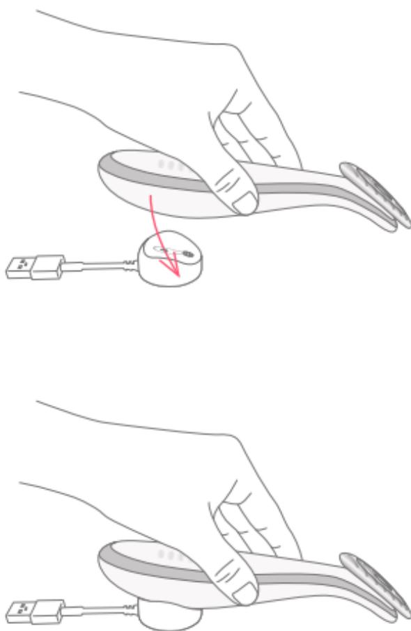
本体をマグネット充電器に正しくセットし充電が始まると本体が1回振動します。充電中はLEDライトのバーが下から上へゆっくりと順番に点灯、約2分後、LEDライトのバーが現時点の充電レベルで点滅します。
